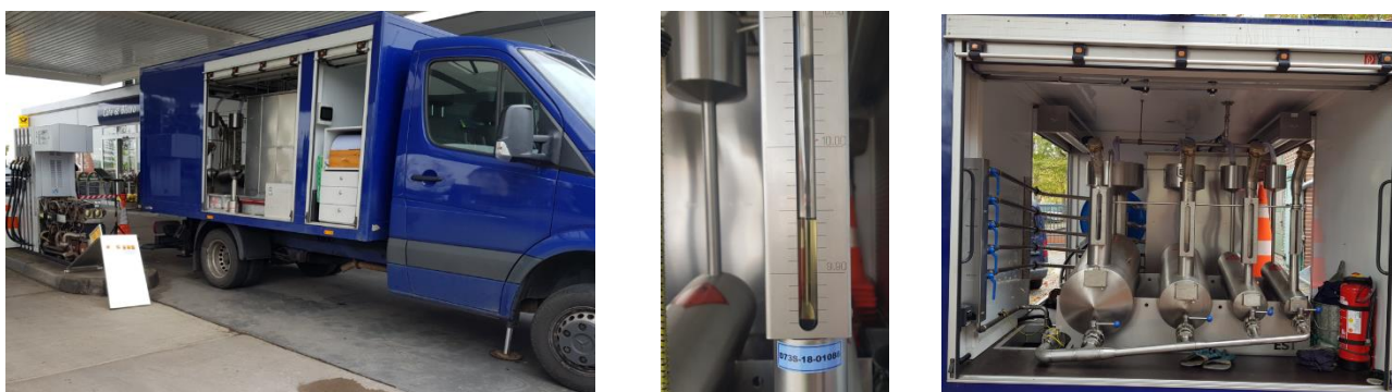
Abb. 1: Eichung einer Straßenzapfsäule unter Einsatz von Volumennormalen
